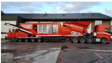
Figuur 3 Mobiele menginstallatie, bij kortdurende activiteiten buiten een inrichting vergunningsvrij.
